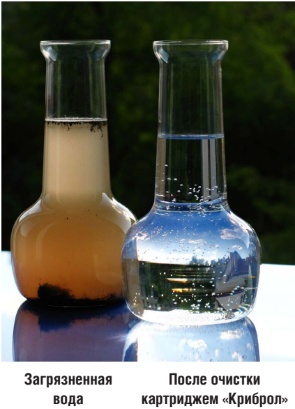
РИС. 2. Результаты технологического процесса разделения водонефтяной эмульсии
